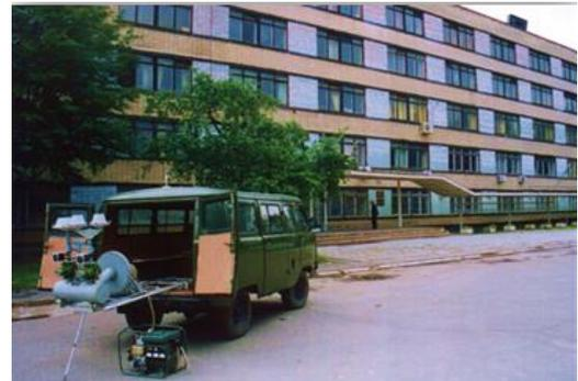
Рис.5.2. Мобильный пробоотборный комплекс МПКГ-1 АО «ННМНПО «ЛУЧ»
